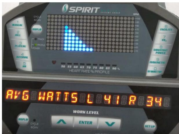
Примечание: В программе Symmetry используется фирменный алгоритм, использующий таблицу силы вычисления скорости для формирования отсчетов в ваттах. Отсчеты берутся не из прямого измерения силы.
