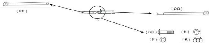
5.-8 Прикрепите поперечину (QQ) к поддерживающей перекладине (PP) с помощью болта (B), шайбы (F), пружинной шайбы (H) и глухой гайки (K).
