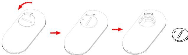
2) Установите в отсек батарейку типа "CR2032" или "CR2025" (3В). Убедитесь, что батарейка установлена с соблюдением полярности. В завершение верните крышку на место и поверните на 90° по часовой стрелке (см. рисунок).
