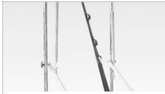
Рисунок 7: Предохранительный ремень удерживает вращающуюся перекладину под углом 4 часа. Ремень закреплен на перекладине и в верхней части рамы, а не на болтах с кольцами.
